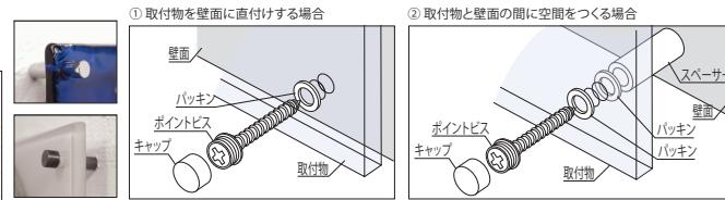
壁面に、取付物をポイントビスでビス止めし、頭部にキャップを閉めて下さい。取付物と壁面との間に空間をもたせる場合は、ポイントビス用スペーサーをご使用下さい。アクリル等にはφ5程度の穴をあけて使用して下さい。
