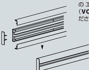
②フレーム組み立てに工具は不要です。図の様にボタンを本体および連結用角パイプ(16/16)の小穴にパチンと固定してください。(その際ボタンの頭部が小穴から確実に出ていることを必ず確認してください)
