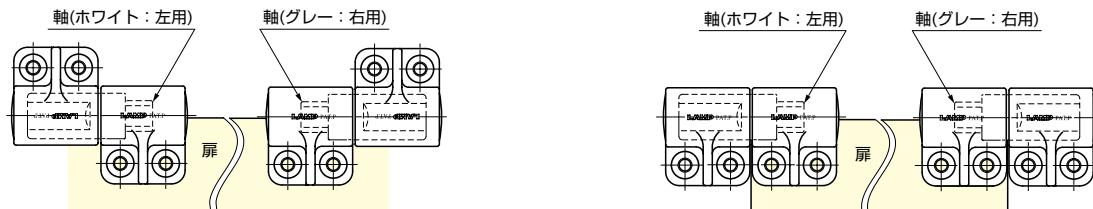
図のように扉を下側に見た場合、ラブコンダンパーは左側に左用（ホワイト）、右側に右用（グレー）を取り付けてください。
