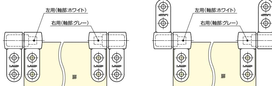
図のように扉を下側に見た場合、ラブコンダンパーは左側に左用（ホワイト）、右側に右用（グレー）を取り付けてください。
