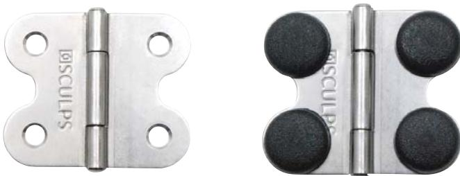
アクリルボックスなど、表面に丁番が見える施工を行うときにビスの頭部を装飾できる丁番です。ビスキャップのカラーバリエーションも豊富で施工場面に合わせて選ぶ事ができます。キャップを使用しない時は3mm径の皿ビスで取り付けを行ってください。
