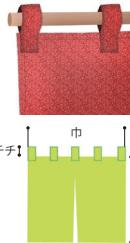
筒の長さは「高さ」に含まれます。筒の長さを指定しなければ通常約50mmであります。チチの間隔は、約200~300mmで取り付けます。
