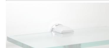
アクリル板は棚板として使用できるマグネットユニットです。アクリル厚さは5~8mmが使用可能、最大120×220まで対応します。左右15°ずつの角度調整が可能です。
