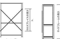
クロスプレイスをクロスさせた時の高さ(h) < サイドフレームの高さ(H)
