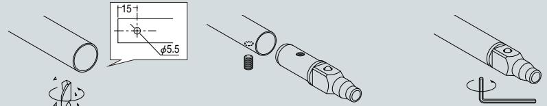
①相手パイプに下穴をあける ②ベースピースを挿入し付属虫ネジを挿入する ③付属の六角レンチで締め上げて固定する
