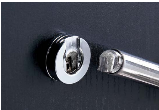
(破壊部詳細) シャフト根元ダイカスト製パーツの破壊
