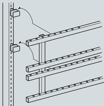
⑤エンドのSF開き止めスッパーとしてスラックスフックエンダー(NFE)を取り付ける事もできます。(その際NFEの小穴に直接SF外れ止め用6φ線材が固定できまるのでNSH付属のコの字金具は8個不要となります)
