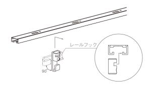
レールフックの取付けは90°回転させるとレールに簡単に 取付けることが出来ます。
