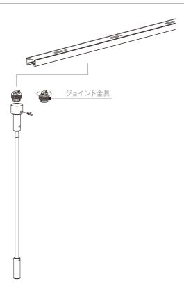
天井レールに取付けるロッドの位置は自由自在。 ロッドのジョイント金具は下部を90°回転させるとレールに 取付けることが出来ます。
