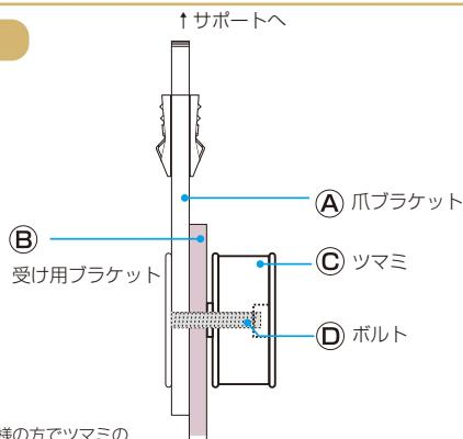
◎①をそれぞれ外して、お客様の方でツマミの左右組み替えが可能です。誤って④と⑤の左右組み替えを行わないで下さい。
