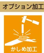
傾斜角度の変更時、ギア部分のパーツがバラバラにならないよう、かしめ加工を承ります。
