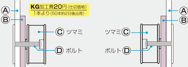
◎ボルト先端を潰してかしめ加工をし、バラバラにならないようにします。
