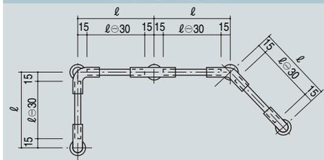
設計上の注意 X ガラス棚板にこぼれ止めを取り付ける際はKN用4.2φ穴はガラス板の強度を充分確保できる位置にあけてください。
