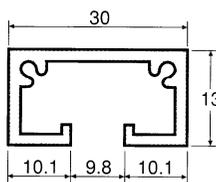
壁付けに使用する、穴なしタイプのレールです。
