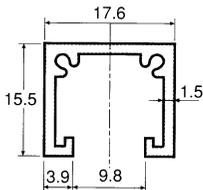
天井付け・壁付けの両方に使用できる、穴なしタイプのレールです。
