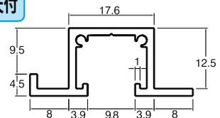
天井付けに使用する、穴なしタイプのレールです。(9mmと12mmボード兼用タイプ)
