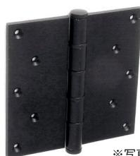
182シリーズの丁番は総でリングや軸芯に油溝を刻み、グリスを充填しています。耐久性、対摩耗性に優れる超高性能丁番です。また、軸芯の抜け止め防止対策としてギボシと軸芯を別々にして、ギボシだけをねじで固定しています。
