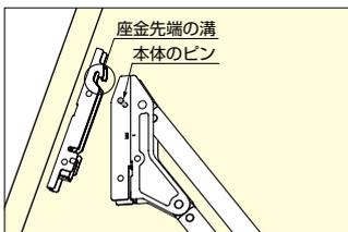
座金先端の溝を本体のピンに引っ掛け、カチッと音が出るまで扉を矢印の方向に押し込みます。
