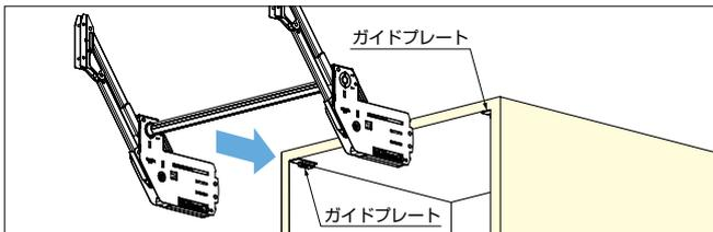
ガイドプレートをキャビネット内側面と小口面に取り付け、連動バーを仮組みした状態で本体を差し込めば、取付位置が決まります。
