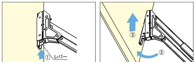
レバーを①矢印方向へ押しながら②矢印方向へ扉を持ち上げ、扉を③矢印方向に動かして取り外します。
