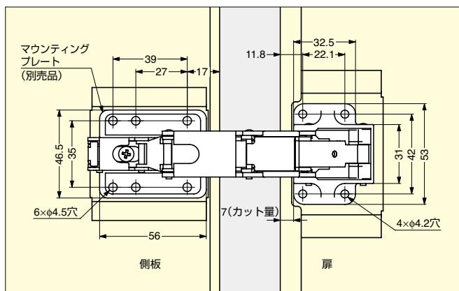
本図はカット量7mm、扉厚30mm、側板厚16mm、かぶせ量15mmの取付位置です。
