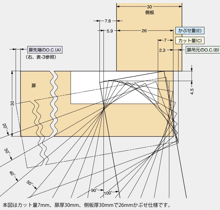
本図はカット量7mm、扉厚30mm、側板厚30mmで26mmかぶせ仕様です。
