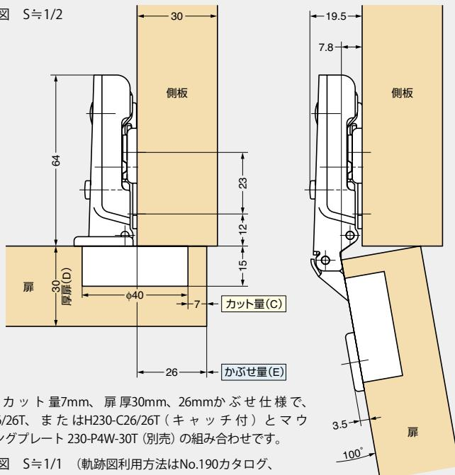
本図はカット量7mm、扉厚30mm、26mmかぶせ仕様で、H230-26/26T、またはH230-C26/26T (キャッチ付) とマウンティングプレート230-P4W-30T (別売) の組み合わせです。
