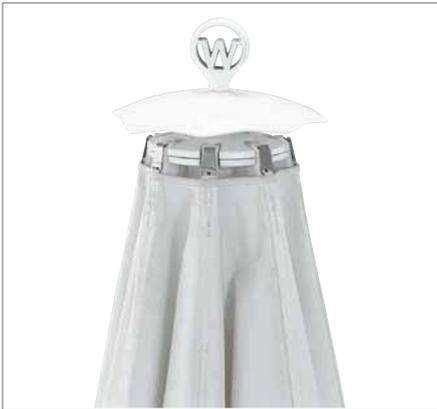
トップキャップには粉体塗装仕上げの堅牢なアルミ材を使用し、フレームのジョイント部を保護します。先端のWマークはヴァイノール社の品質の証で持ち運びの時の持ち手になります。
