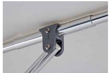
強化ジョイント 長骨と短骨はアルミスリーブをかぶせてジョイント するので風による強い力を分散します。
