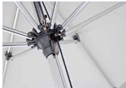
トゥウチ特許の独立ブラケットシステム テフロン加工されたデルリン樹脂(POM) ハブに ステンレス金具でアルミの骨を連結します。
