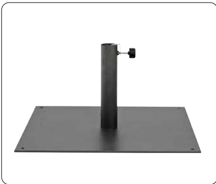
●PB-8253/SG (スチールグレイ) □600×600×H310mm パラソル支柱/φ55mm用 主材/スチール粉体塗装 重量/24.0kg
