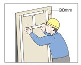
●仕上げ材の端部に接着剤を塗布するためのスペース30mmをあけて、仮止めの両面テープを貼り付けてください。
