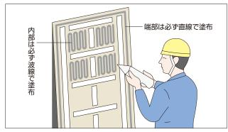
●面材に接着剤(変成シリコン系)を塗布してください。 【推奨接着剤はP57を参照】
