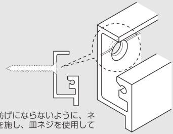
フックの移動の妨げにならないように、ネジ穴は皿穴加工を施し、皿ネジを使用してください。
