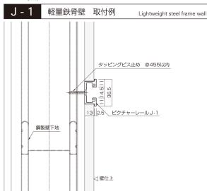
●J-1レールのネジ穴加工 フックの移動の妨げにな らないように、ネジ穴は 皿穴加工を施し、皿ネジ を使用してください。
