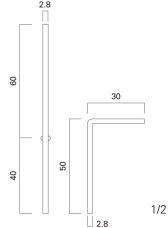
ジョイントピン コーナージョイントピン Joint pin Corner joint pin
