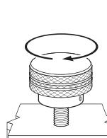
市販のM6の六角穴付きボルトを矢印の方向へ差し込みます。
