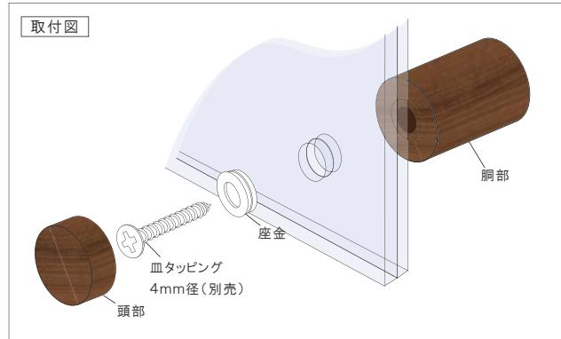
壁面に対し、サインナット胴部・取付物・座金の順にビス止めし、取り付けた座金にサインナット頭部を取り付けて下さい。取り付けには、太さ4mmの皿タッピングをご使用下さい。適応板厚は、12mmまで目安(P.011)。タッピングの長さについては011ページの取り付けビスの選び方をご覧下さい。アクリル板等に $\phi 6$ の穴を開けてご使用下さい。
