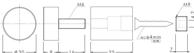
壁面に座金をタッピングで打ち付け、座金に胴部を取り付けます。取付物にあけた穴にサインナット頭部のねじ部とパッキンを通し、胴部に取り付けてください。取り付けには、太さ4mmの皿タッピングをご使用下さい。長さについては11ページの取り付けビスの選び方をご覧下さい。適応板厚:11ページ参照。アクリル板等に  $\phi 8$  の穴をあけてご使用下さい。サインなどの取付物の交換をする際は、サインナット頭部のみを取り外し、交換後再度サインナット頭部を胴部に取り付けて下さい。
