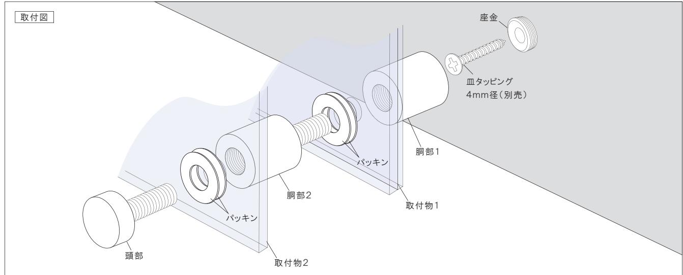
壁面に座金をねじ径4mmの皿タッピングで打ちつけ、胴部1を取り付けます。下穴をあけた取付物1とパッキンに胴部2のねじ部を通し、胴部1にねじ込みます。下穴をあけた取付物2にパッキン、頭部の順に取り付けます。
