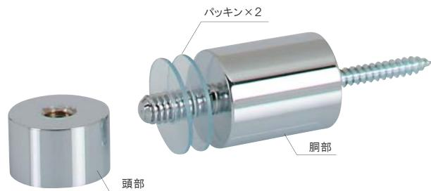
胴部側にボルトが付いています。頭部を外しても面板が外れないため、落下の危険性が少なく掲示物の差し替え作業が簡単にできます。アクリル板などにΦ6の穴をあけてご使用ください。取付物厚さ5~8mmに対応。
