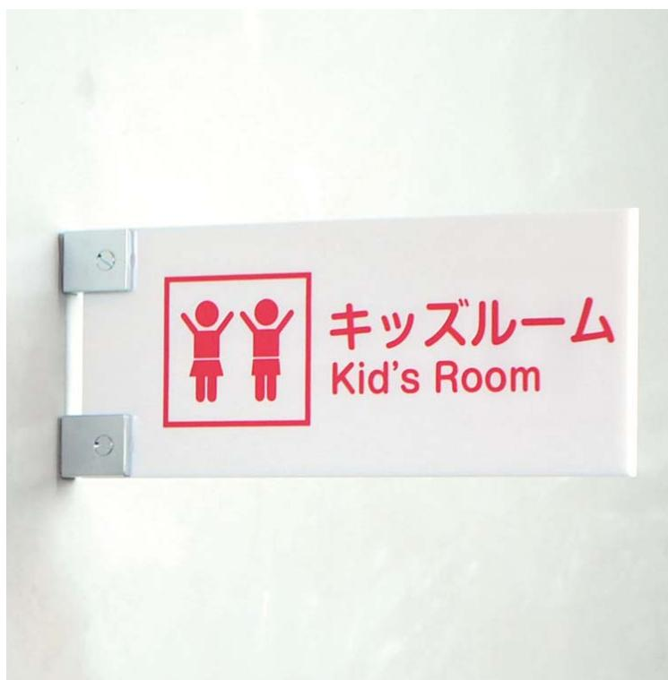
イージーピクト50の半分のサイズのピクトサイン金具です。施工方法はイージーピクト50と同じくサインパネルにΦ7の穴をあけるだけの簡単加工です。壁への取り付けは別体パーツを使用すること無く、金具に直接ビスを打ち込むタイプです。金具の単純構造化はかり、施工の短縮化を実現。全てのパーツが削り出で製造されており、仕上げは鏡面クロームメッキです。
