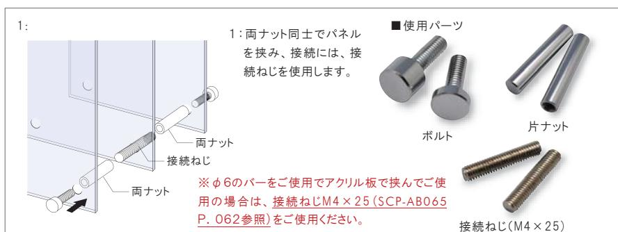
パネルとパネルの間に両ナットを使用します。両端のパネルは、ボルトを使用してナットに接続してください。両端以外のパネルには、接続ねじを使用してナットに接続してください。接続ねじと両ナットの数を増やせば、複数枚のパネルをつなぐことができます。
