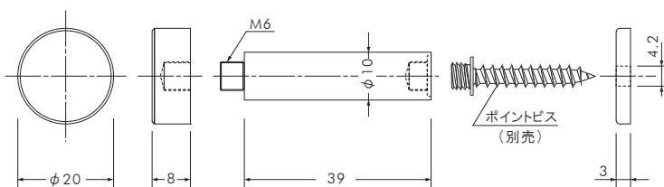
壁面に対して座金をポイントビスで打ち込み、ポイントビス頭部に胴部・キャップを取り付けます。
