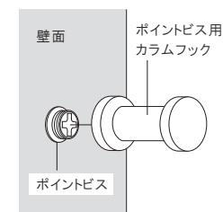
壁面に対してポイントビスを打ち込み、ポイントビス頭部にフックを取り付けて下さい。
