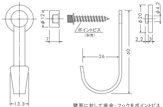
壁面に対して座金・フックをポイントビスで打ち込み、ポイントビス頭部にキャップを取り付けます。
