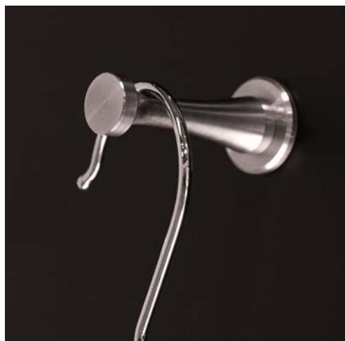
ポイントビス用フックは、特殊ビスである【ポイントビス】(P.032参照)を取り付けに使用することにより、取り付けが簡単で外側からはねじの見えない施工を行なう事ができます。ステンレス(SUS303)の丸棒から削り出して製造しており、高級感のある挽目を残した加工によりステンレス独特の質感に仕上がっています。
